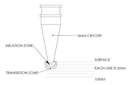
CROSSHATCHED AREA IS THE ABLATION ZONE ABLATION ZONE IS COLDER THAN -20\*C TRANSISTION ZONE IS BETWEEN 0\*C AND -20\*C BASED ON FREEZING OF BALLISTIC GELATIN
