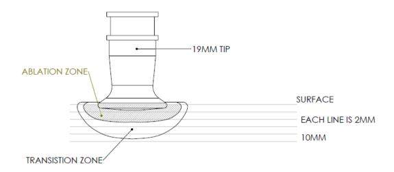
CROSSHATCHED AREA IS THE ABLATION ZONE ABLATION ZONE IS COLDER THAN -20\*C TRANSISTION ZONE IS BETWEEN 0\*C AND -20\*C BASED ON FREEZING OF BALLISTIC GELATIN
