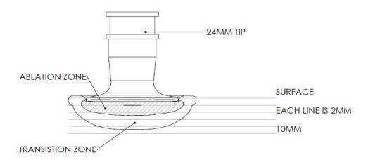
CROSSHATCHED AREA IS THE ABLATION ZONE ABLATION ZONE IS COLDER THAN -20\*C TRANSISTION ZONE IS BETWEEN 0\*C AND -20\*C BASED ON FREEZING OF BALLISTIC GELATIN
